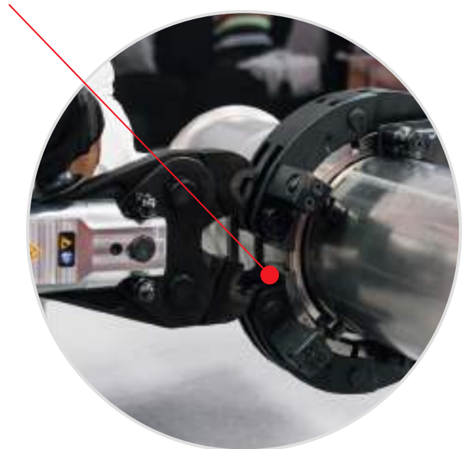
Scanalatura della catena sopra la sede di contenimento dell'o-ring Chain groove above the o-ring groove
